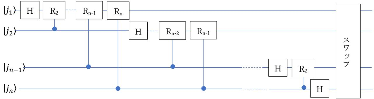
上記で  $R_m$  は、制御ビットが  $|0\rangle$  のときは標的ビットをそのまま通し、制御ビットが  $|1\rangle$  のときは、
